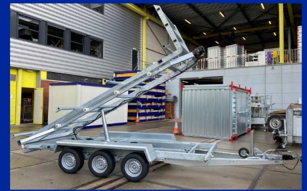
5-traps, zeer sterke cilinder, met 48° kiphoeke (geschikt tot 6100 kg)
